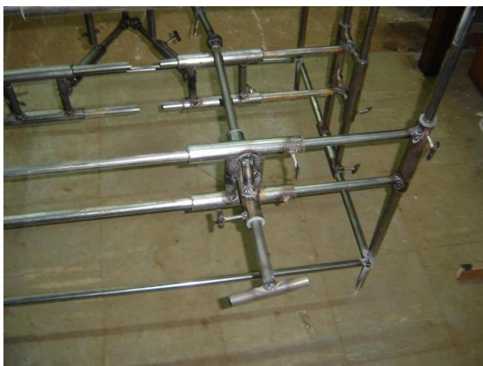
Fig. 30 – Manopla que simula a ação de uma cremalheira.
