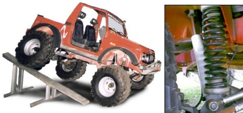
Fig. 20 – Conjunto amortecedor-mola em um veículo off-road .
