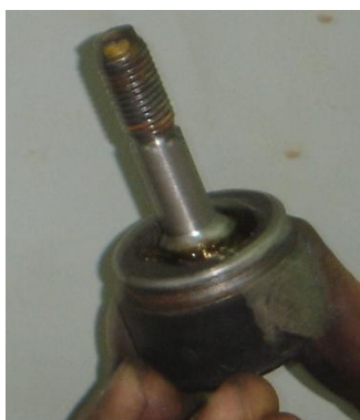
Fig. 24 – Junta esférica adaptada de um terminal de direção de um veículo de mercado.
